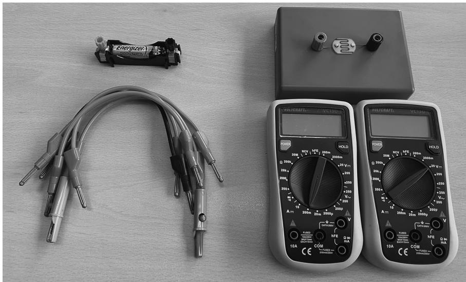
Bram sluit de LDR en twee multimeters aan op een batterij. Met de ene multimeter meet hij de spanning over de LDR en met de andere meet hij de stroomsterkte door de LDR. Met deze gegevens berekent hij de weerstand van de LDR.
